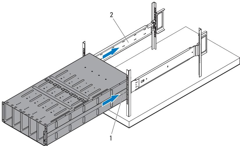
**2** 使用四颗 10-32 螺钉<sup>1</sup> 将机柜正面固定至左侧和右侧机架柱。
