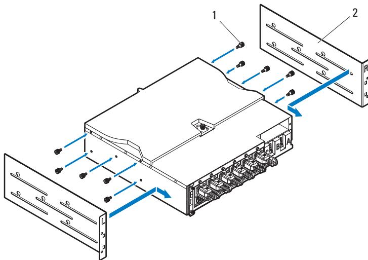
5 将通风装置安装到 PDU 上。
