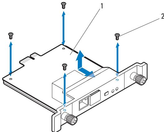
b 将 PMC 部件<sup>1</sup> 插入到 PDU 并用两颗指旋螺钉<sup>2</sup> 固定。
