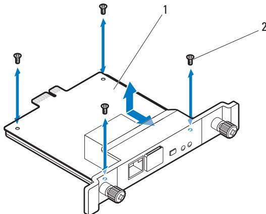
b PMC アセンブリ<sup>1</sup>を PDU に挿入し、2 個の蝶ネジ A で固定します。
